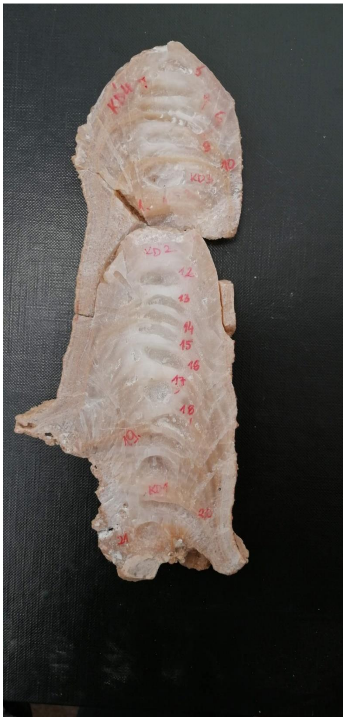
Fig. 4. Fotografia nacieku KDC dokumentująca pobrane warstwy do datowania metodą U-Th.
